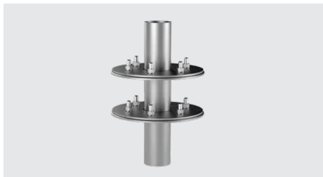
Flasque en acier inoxydable avec 2 flasques fixes/amovibles à cheiller sur toits plats isolés avec deux feuillards d'étanchéité selon DIN 18531
